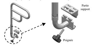
2- Monter le lit à son plus haut. Placer la partie support de la barre <u>au-dessus</u> de la structure, en dessous du joint entre la tête et la fesse de la plate-forme, tel qu'indiqué;
