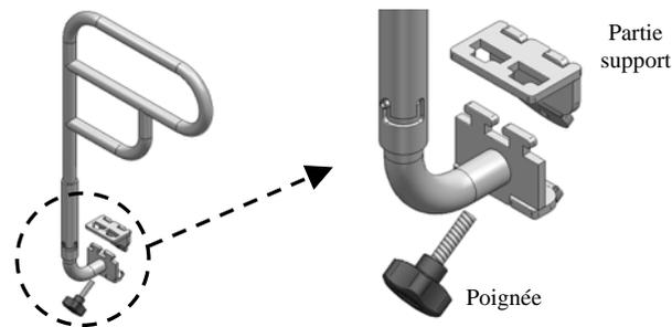
2- Monter le lit à son plus haut. Placer la partie support de la barre au-dessus de la structure, en dessous du joint entre la tête et la fesse de la plate-forme, tel qu'indiqué;
