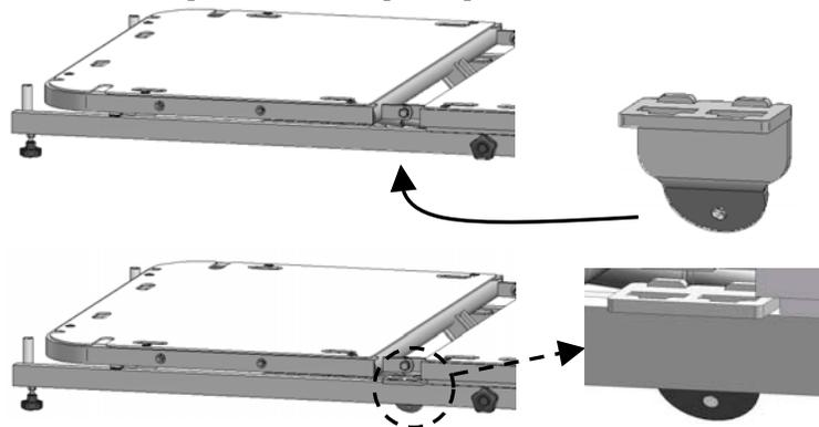
3- Installer la barre et insérer les deux (2) dents dans les trous de la partie support. Pour faciliter cette opération, lever un peu la partie support et insérer la barre en lui donnant un angle;
