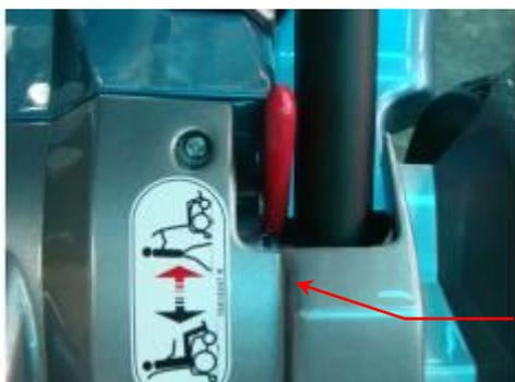
**Levier roue libre/** Force maximale à appliquer est 19 N pour engager le levier et 35 N pour le désengager
