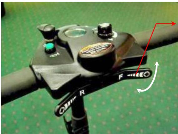
Levier de contrôle/Force maximale à appliquer est 4N
